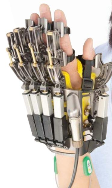
希望之手需要佩戴在患者功能受損的手上。兩個肌電傳感器分別放在伸肌和屈肌的皮膚表面。肌電傳感器會讀取到手臂肌肉的電信號，電腦系統會因應信號控制機械手的開合，從而帶動患者的手部運動。
